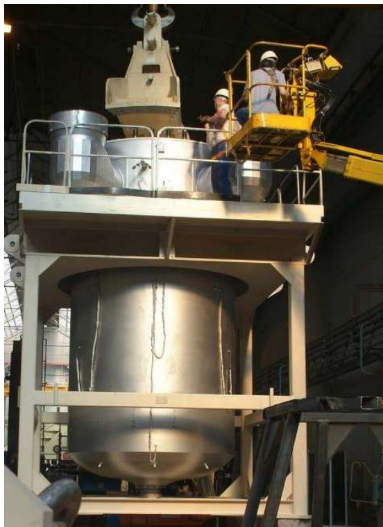
ル・トリオンファン級原潜(14000t)用原子炉吊り下げ作業 https://sgs.princeton.edu/sites/default/files/2019-11/philippe-vonhippel-2016.pdf
